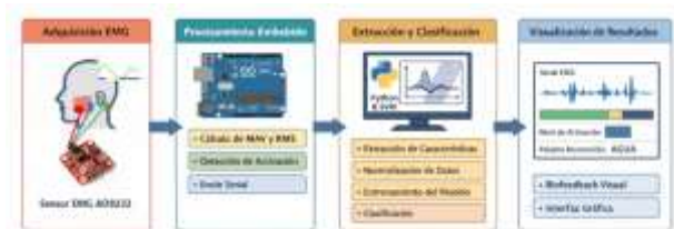
Figura 1. Arquitectura del sistema de reconocimiento de contracciones musculares faciales basado en EMG
