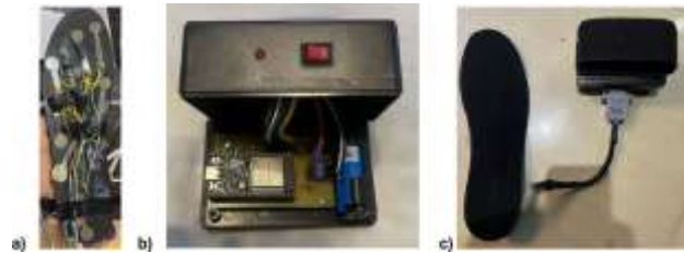
Figura 5. Resultados del diseño y fabricación de la plantilla sensorizada
