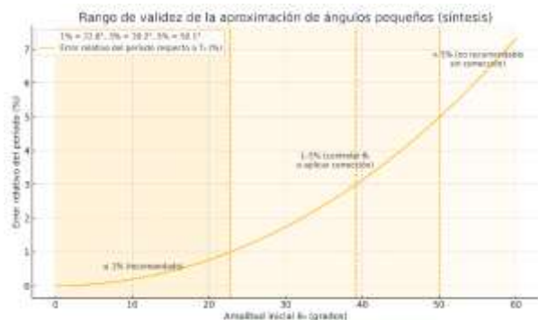
Figura 3. Rango de validez de la aproximación de ángulos pequeños. Bandas de amplitud en grados con valores orientativos del error relativo \varepsilon(\theta_0) = [T(\theta_0) - T_0]/T_0 obtenidos de la expansión T/T_0 \approx 1 + \theta_0^2/16 + 11\theta_0^4/3072 (radianes).
